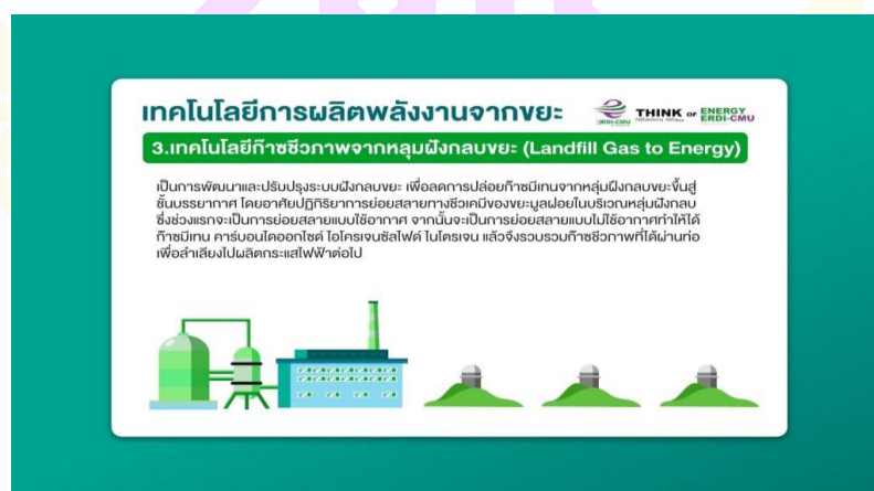
ภาพ 9 การทำงานเทคโนโลยีก๊าซชีวภาพจากหลุมฝังกลบขยะ (Landfill Gas to Energy)
