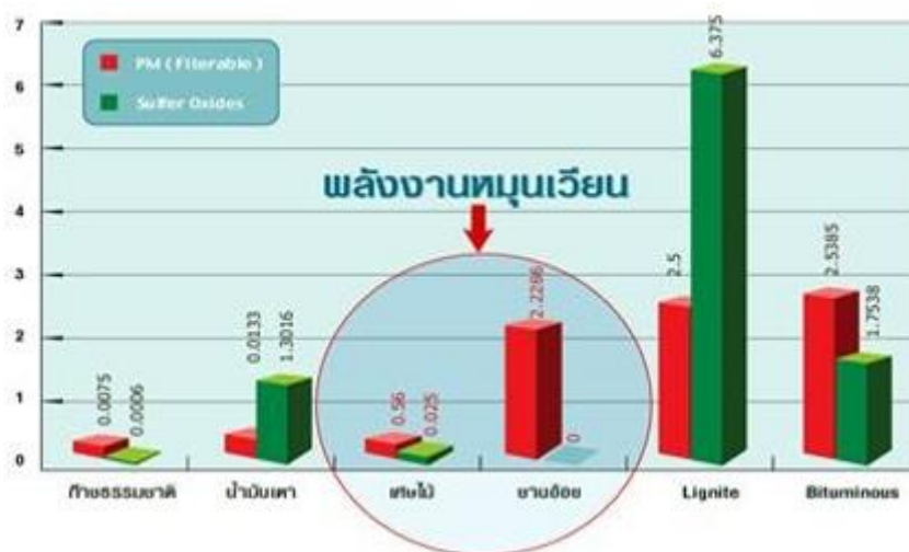
ภาพ 1 การเปรียบเทียบ PM และ Sulfur Oxide ที่เกิดจากพลังงานประเภทต่าง ๆ
