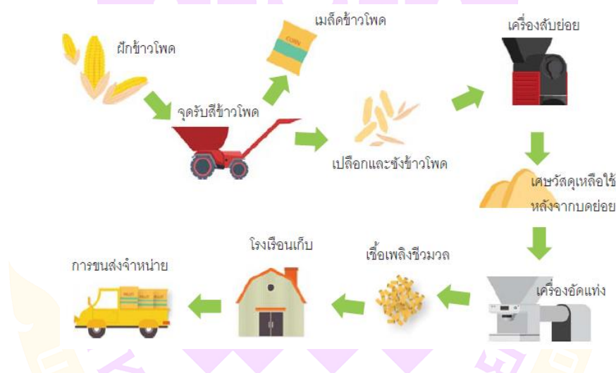
ภาพ 31 แสดงกระบวนการผลิตเชื้อเพลิงอัดแท่ง (wood pellet)
