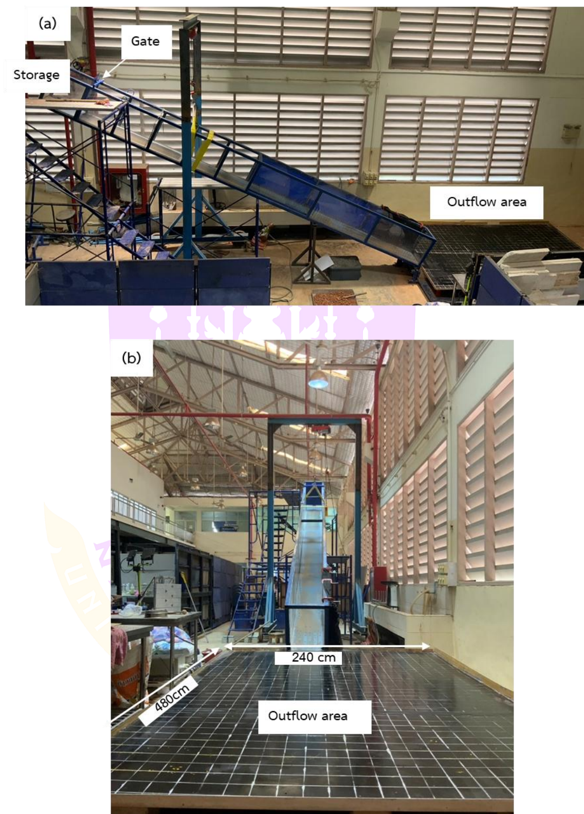
ภาพ 37 แบบจำลองทางกายภาพในห้องปฏิบัติการ (a) ด้านข้าง (b) ด้านหน้า
