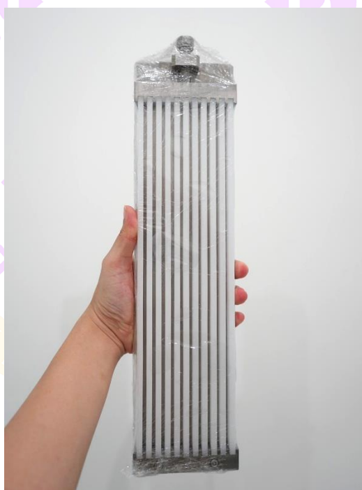
ภาพ 21 แบบหล่อตัวอย่างซีเมนต์เฟสท์ ขนาด 3×13×300 มม.
