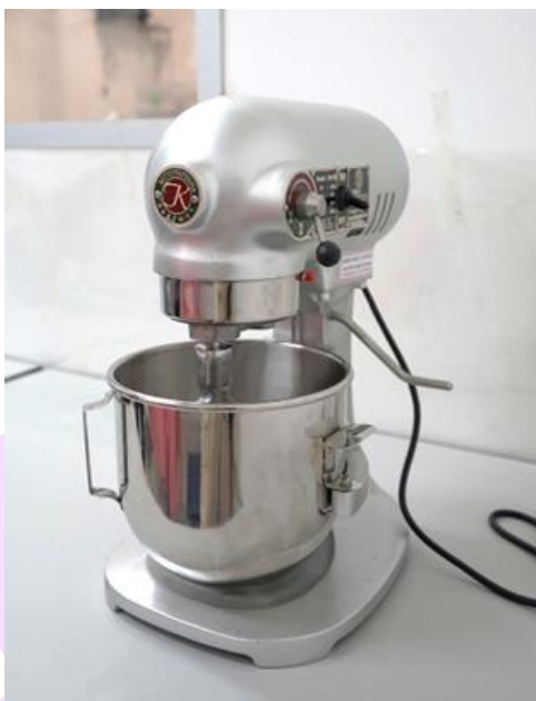
ภาพ 20 เครื่องผสมซีเมนต์เฟสท์แบบไฟฟ้า ขนาด 5 ลิตร
