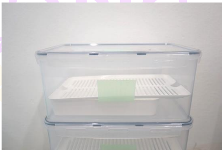
ภาพ 19 กล่องสำหรับบ่มตัวอย่างซีเมนต์เพสต์ในสภาวะปิดผนึก
