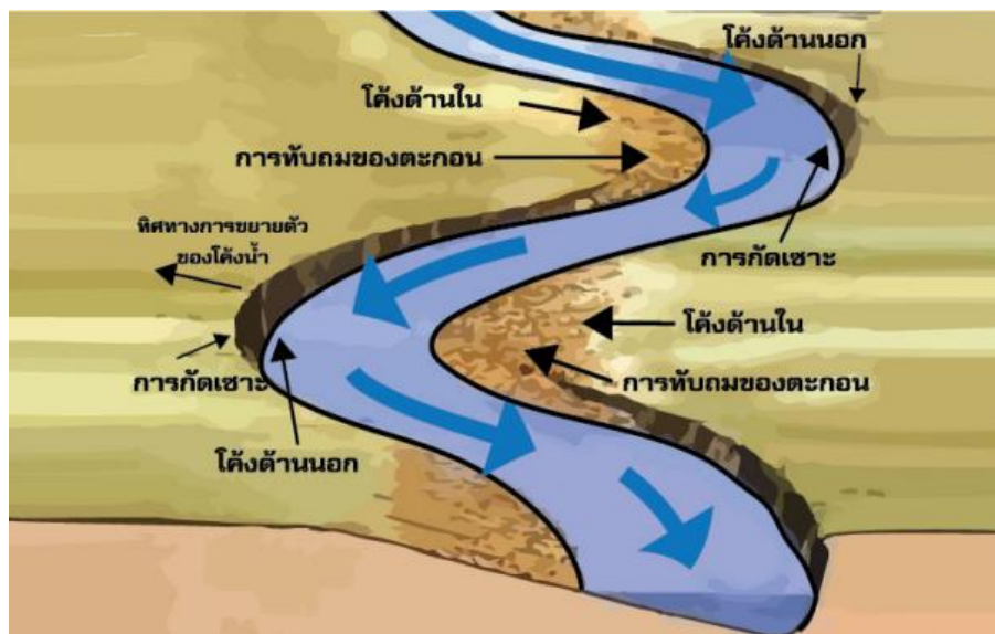
ภาพ 14 ลักษณะการกัดเซาะในโค้งลำน้ำที่คดเคี้ยว
