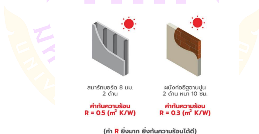
ภาพ 8 ค่าการกันความร้อนของผนังสมาร์ทบอร์ดและผนังก่ออิฐ
