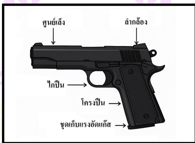
ภาพ 2 โครงสร้างของปืนบีบีกัน (BB Gun) แบบอัดแก๊ส (Gas Blowback)
