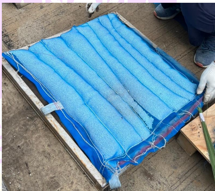
ภาพ 55 นำถุงสารดูดซับยัดไว้กับแผ่นฟิลเตอร์
