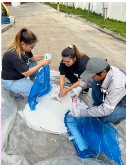
ภาพ 53 กรอกสารดูดซับ (Molecular Sieve)
