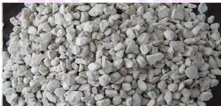
ภาพ 13 ซีโอไลต์ มีลักษณะเป็นผลึกมีรูพรุนเท่ากันตลอด
