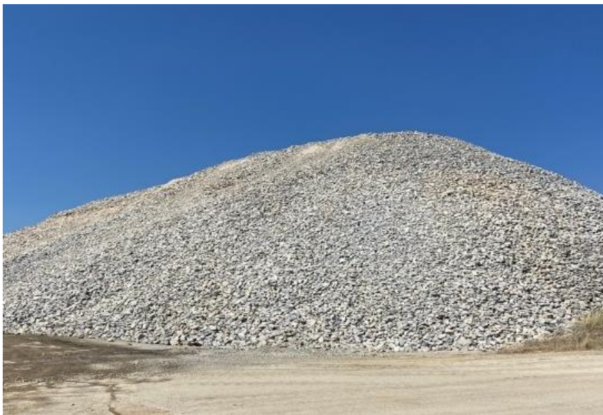
ภาพ 8 หินคลุกที่ใช้ในชั้นรองหินโรยทาง (subballast)
