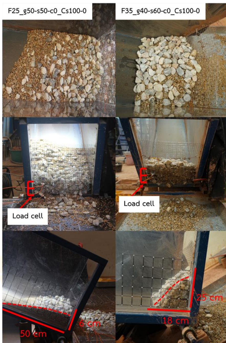
ภาพ 85 การกระแทกบนโครงสร้างป้องกันแบบยืดหยุ่นจากการทดลอง F25_g50_s50_c0_Cs100-0
