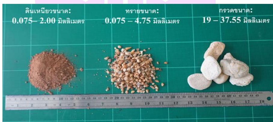
ภาพ 34 วัสดุที่ใช้ในการทดลอง ประกอบด้วยดินเหนียว ทราย และกรวด
