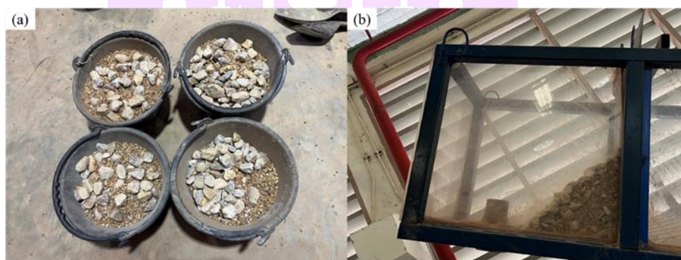
ภาพ 38 (a) การเตรียมตัวอย่างวัสดุเม็ดแห้ง (b) ขั้นตอนในการเตรียมปล่อยตัวอย่าง
