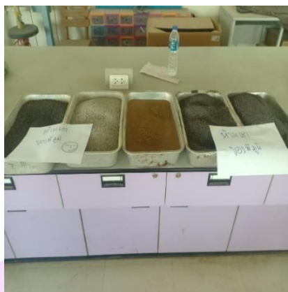
ภาพ 36 แสดงเถ้าลอย เถ้าหนัก ทราย และคอนกรีตรีไซเคิล
