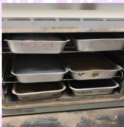
ภาพ 35 แสดงการนำ เถ้าลอย เถ้าหนัก ทรายธรรมชาติ และคอนกรีตรีไซเคิลเข้าเตาอบ
