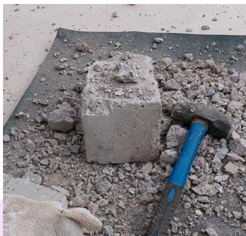
ภาพ 31 แสดงชิ้นส่วนเสา และคานคอนกรีต ย่อยโดยใช้ค้อนปอน
