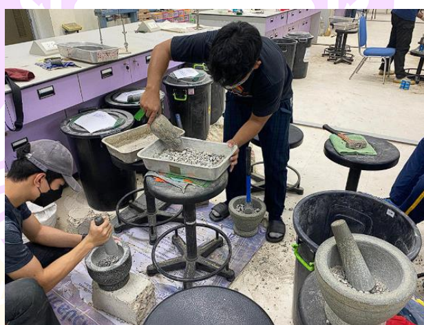
ภาพ 32 แสดงชิ้นส่วนเสา และคานคอนกรีต ย่อยโดยใช้ครกหิน
