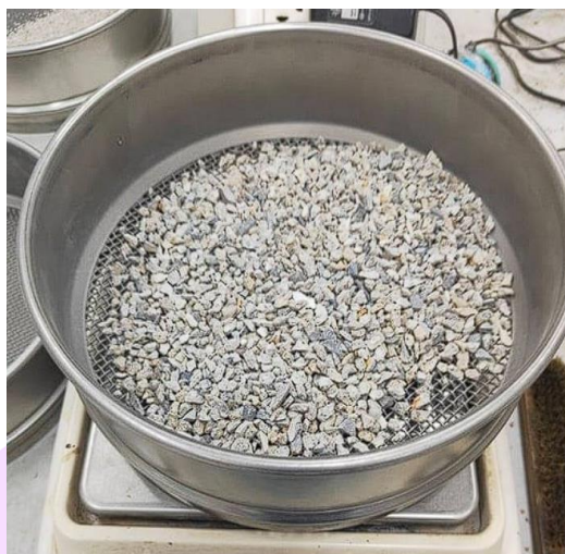
ภาพ 33 แสดงคอนกรีตไรโซเคิลที่ร่อนผ่านตะแกรงเบอร์ 4
